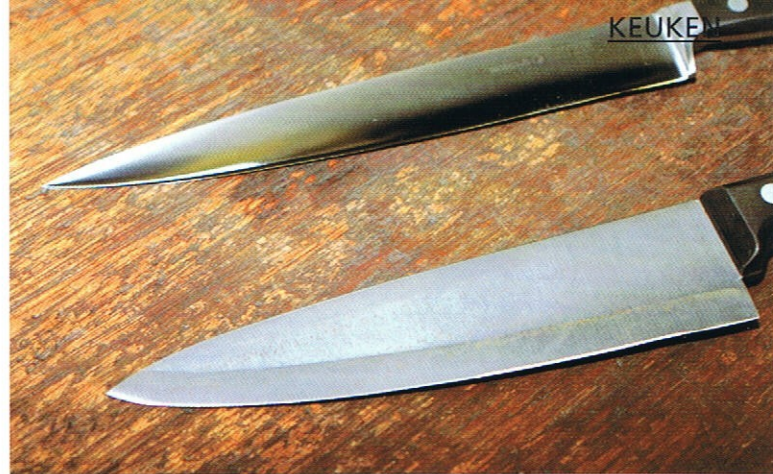
Bovenaan een konisch bol geslepen mes, onderaan een hol geslepen profiel, het eerste kun je makkelijk scherp houden en opnieuw slijpen, het onderste niet
