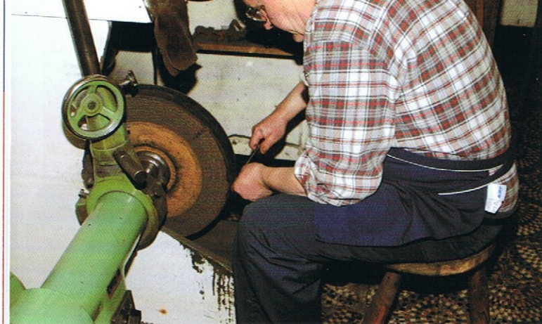
Geen enkel mes blijft eeuwig scherp, messenslijpen is een echte ambacht. Messenslijper Herwig Degryse aan het werk in de typische Duitse houding, zo doen ze het in Solingen ook
